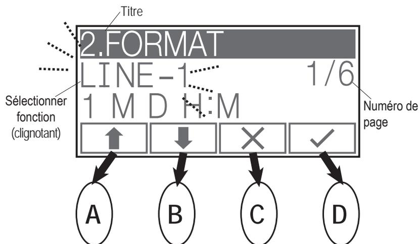
Les fonctions des touches de commande (A-B-C-D) sont affichées sur l'écran LCD au moyen de symboles. Pour exécuter une fonction clignotante, il suffit de presser la touche correspondante.
